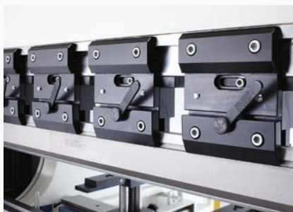
Oberwerkzeughalterung mit Schnellwechselsystem
