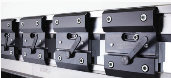
Oberwerkzeughalterung mit Schnellwechselsystem
