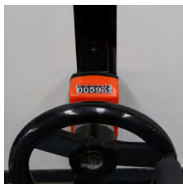
Mechanische Messeinrichtung des Hinteranschlags
