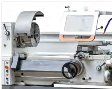
Drehend gelagerter Sicherheitsfutterschutz & beweglicher Späneschutz
