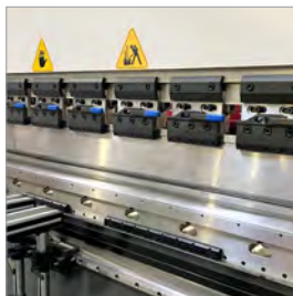
Oberwerkzeughalterung mit Schnellwechselsystem
