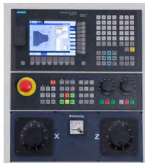
Zentrales Bedienpanel mit zwei elektronischen Handrädern
