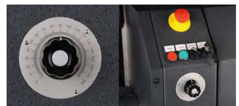
Inklusive manueller Winkeleinstellung mittels Potenziometer
