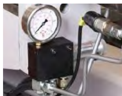
Spanndruckregelung des Spannstockes
