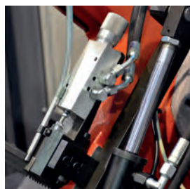
Hydraulische Schnittdruck- überwachung bei DGH-Modellen
