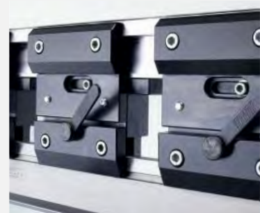
Oberwerkzeughalterung mit Schnellwechselsystem
