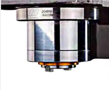
Taiwanische Frässpindeln mit 10.000 UpM
